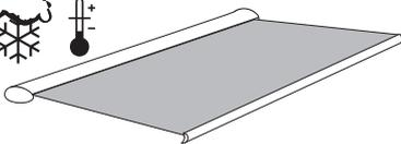
Markise kann einfrieren! Vermeiden Sie eine gewaltsame Betätigung und schalten Sie die Automatik auf manuellen Betrieb.
