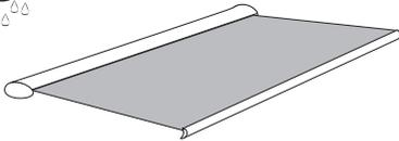
**VORSICHT** Ist die Neigung der Markisen geringer als  $15^\circ$  (gemessen von der Waagrechten), so darf sie bei Regen nicht ausgefahren werden. Es besteht die Gefahr von Wassersackbildungen im Markisentuch. Dadurch kann die Markise beschädigt und Menschen können gefährdet werden.
